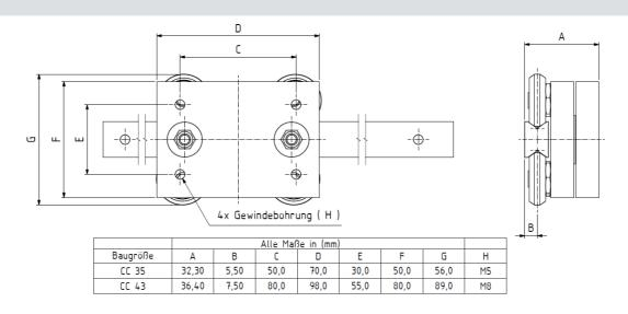
Verfügbare Schienenprofile: CC 35: 15,5 x 10,10 mm
